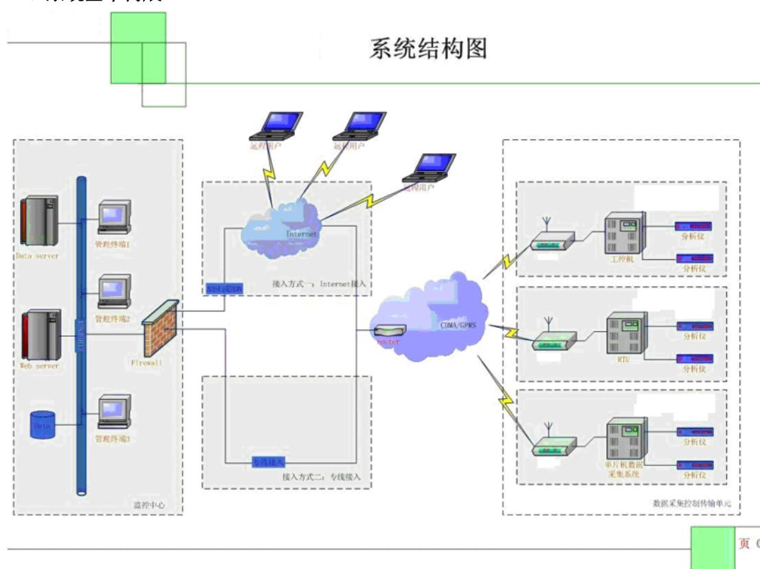
本系统结构如图所示，系统主要由采油场监控中心和油井无线遥测遥控主机、传感器、电机控保装置等组成。采油场监控中心一般设置在矿部、队部或其它监控调度部门；油井工作状态传感器主要有温度传感器，电压传感器，电机电流传感器，被监控开关断/合传感器，它们将油井的工作状态转换成对应的电压或电流值送至 RTU。本系统留有扩展接口，可根据油井实际情况增加。
